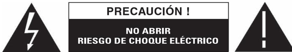
El símbolo del rayo con punta de flecha dentro de un triángulo equilátero intenta alertar al usuario acerca de la presencia de voltaje peligroso no aislado dentro de la carcasa del producto que puede ser de tal magnitud que constituya un riesgo de golpe eléctrico para las personas.
